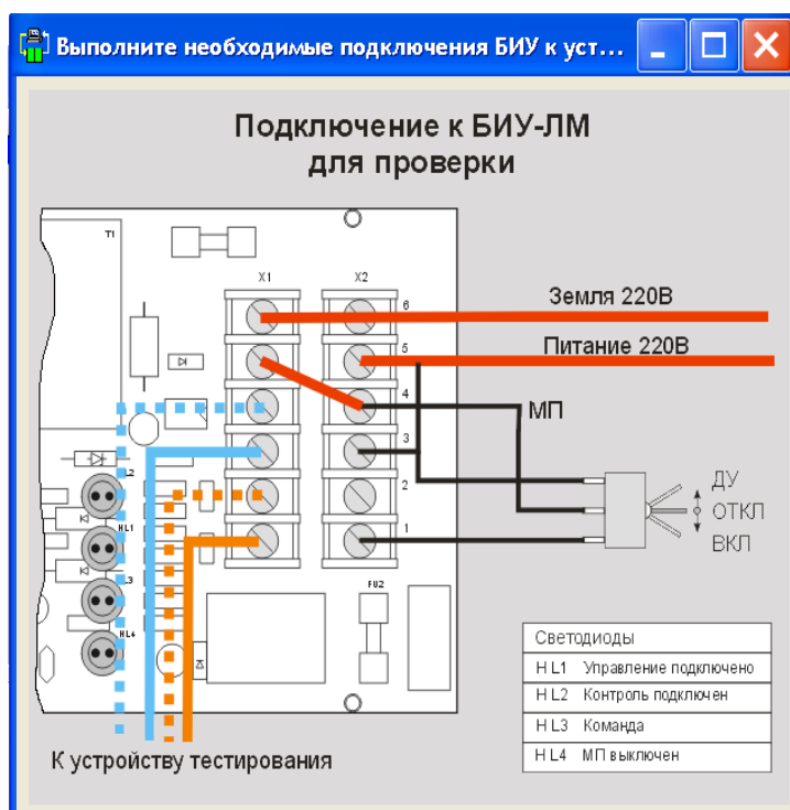
Рисунок 11 - Схема подключения БИУ-Л к Т-СЛДКС
